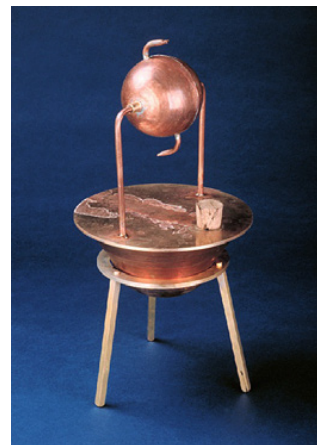
Äoliphile, Dampfmaschine des Heron. Das Wasser wird im kugelförmigen Kessel erhitzt.
