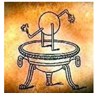
Äoliphile, Dampfmaschine des Heron. Das Wasser wird im kugelförmigen Kessel erhitzt.
